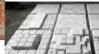
MUSTERMIXDÄMMUNG DER GEOMETRIE Definierte Wärmedämmung durch individuelle Verteilung von geometrischen Formen.
