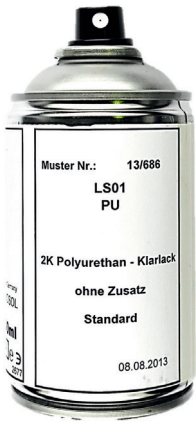
Abb. 2: Professionell abgefüllte Lackspraydose auf Treibmittelbasis, wie sie für die Untersuchungen zur Freisetzung bei der Sprüh- und Spritzapplikation von Flüssiglacken eingesetzt wurde.
